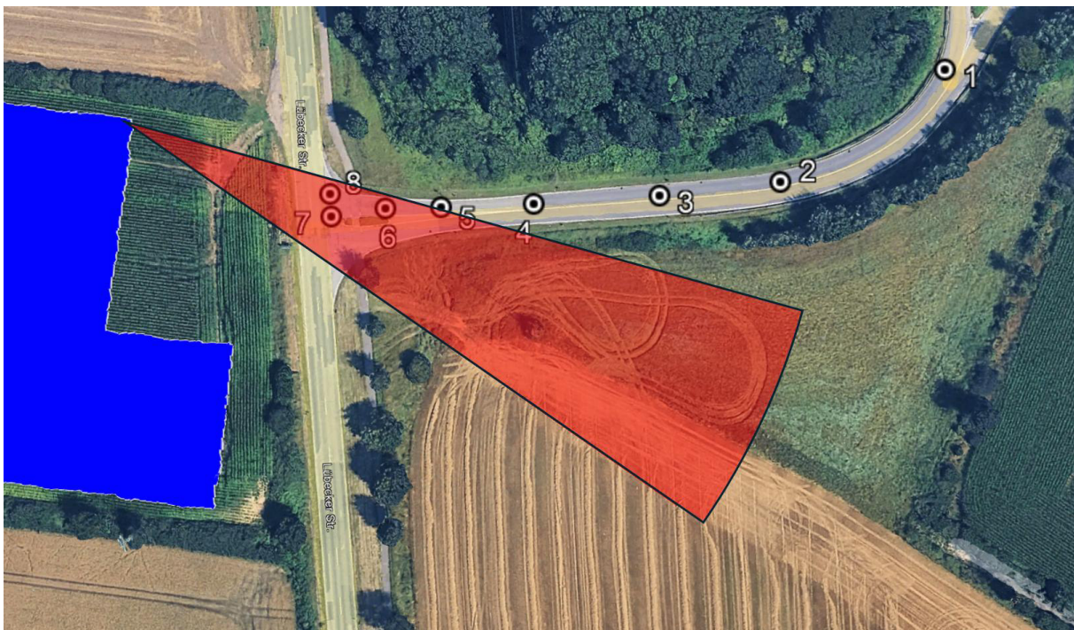
Abbildung 14: Emissionswinkel möglicher Reflexionen von der Modulfläche mit Aufweitung für die Position 5 in Rot
