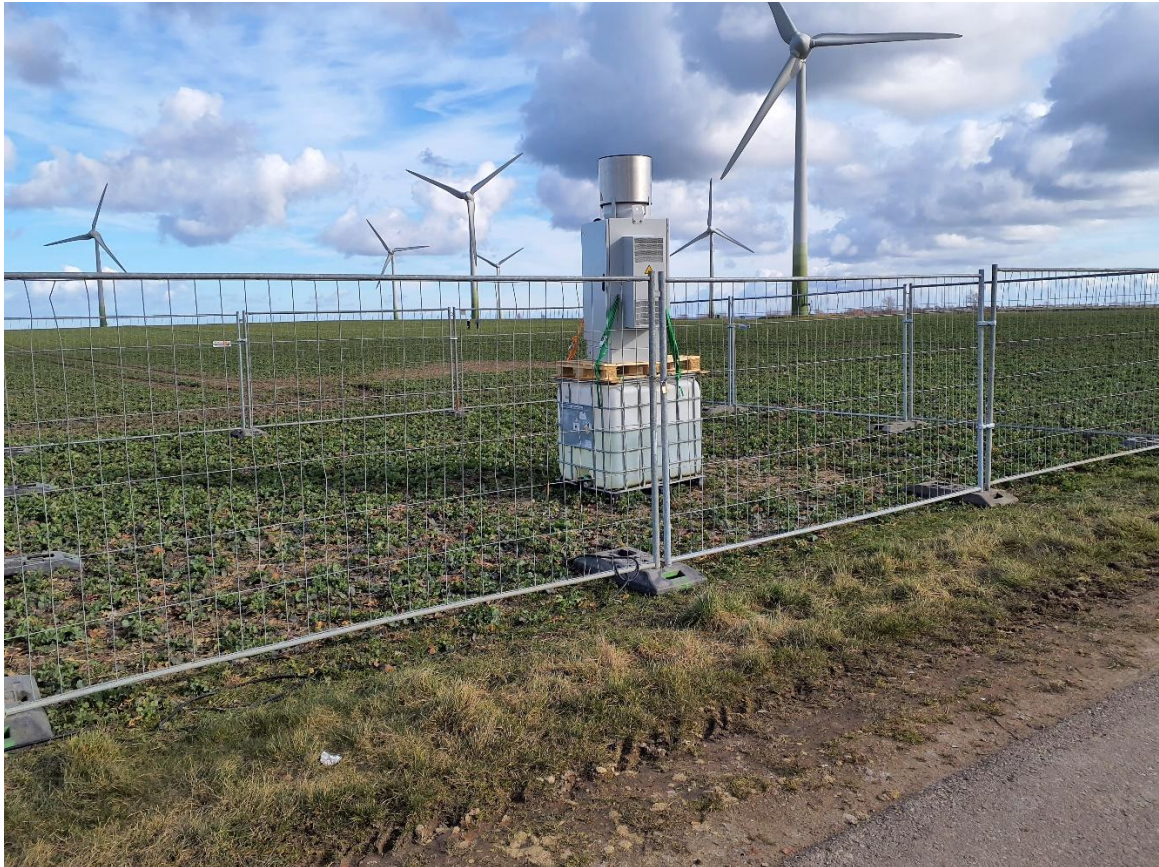
Abb. 2.1 Radar BirdScan MR1 von Swiss Birdradar Solution AG; an der westlichen Grenze des Bestandswindparks Fehmarn Klingenberg.
