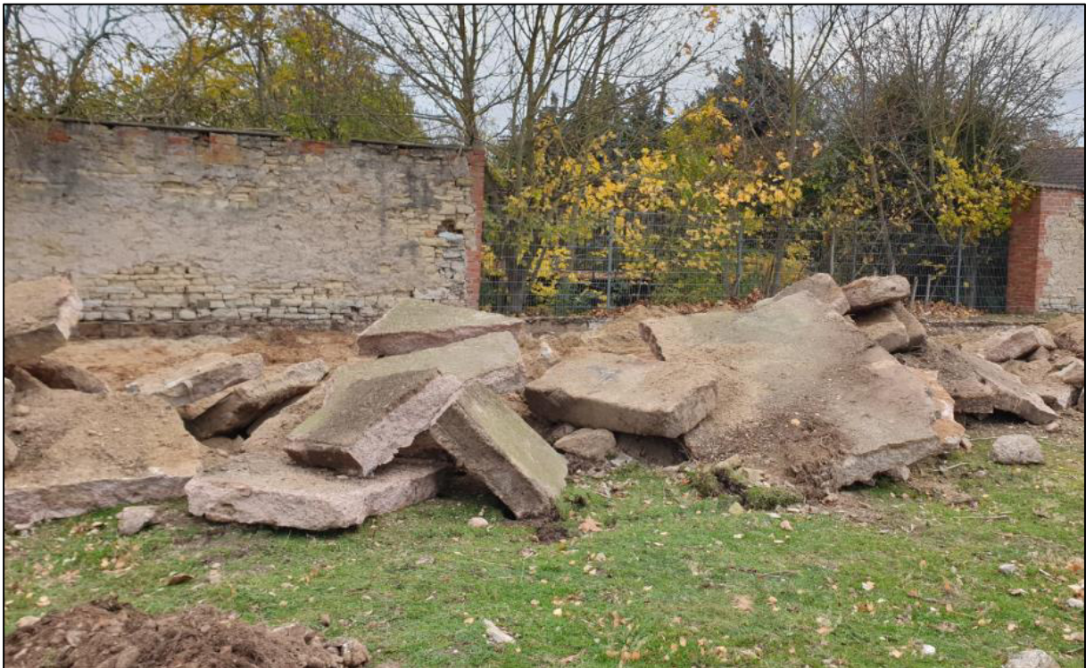
Abbildung 6: Beton aus gebundener Tragschicht im Untersuchungsbereich
