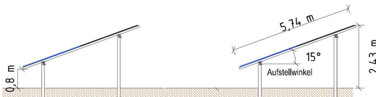
Bild 3.3.1: Skizzen der Modulkonstruktion (Quelle: Systemplanung, Auftraggeber)
