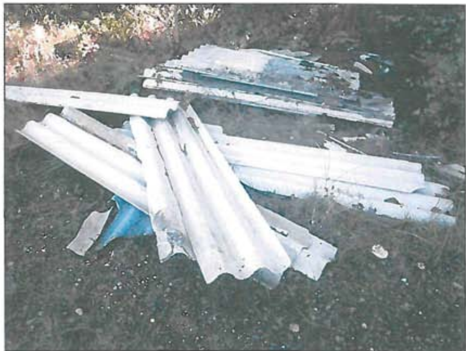
Abb. 5: 05.06.2013 – auf dem Untersuchungsgelände lagern diffus verteilt u. a. schadstoffhaltige Abbruchmaterialien (hier Asbestzement-Wellplatten).
