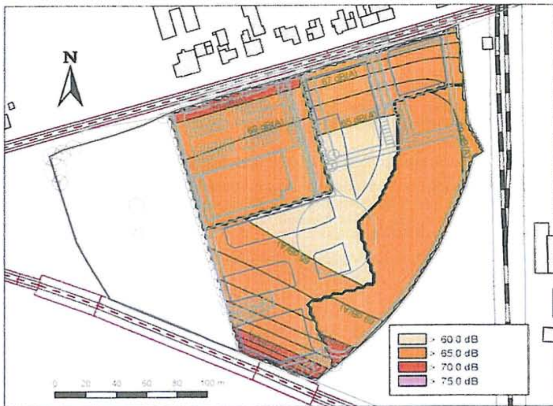
Abbildung 8 - maßgeblicher Außenlärmpegel für schutzbedürftige Räume - unmaßstäblich
