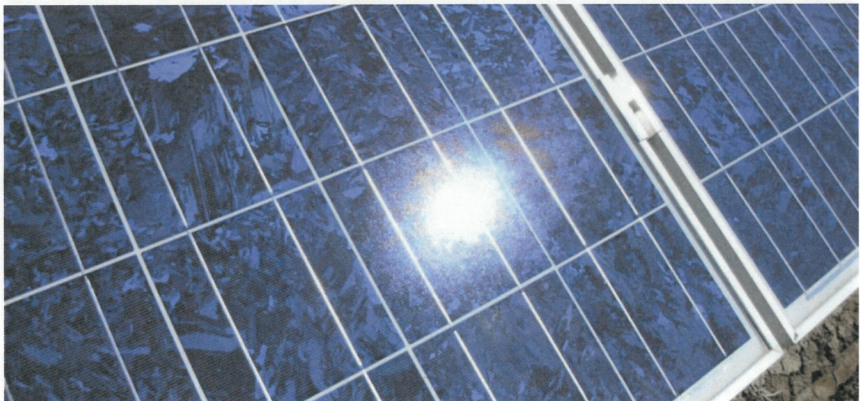
Bild 3.2.2: Diffuse Reflexion von direktem Sonnenlicht (Einstrahlung ca. 980 \text{ W/m}^2 ) auf einem PV Modul (Quelle: SolPEG)
