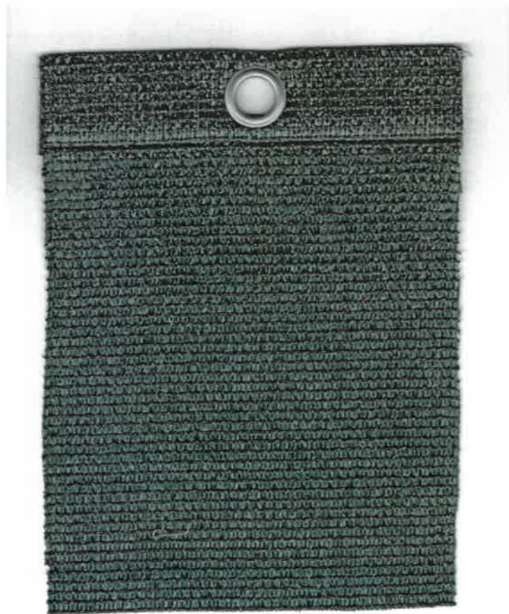
Bild 8: Untersuchtes Kunststoffgewebe, Lieferant Fa. evia Verkehrstechnik GmbH/ACCURA NTV KG Maßstab: ca. 1:2
